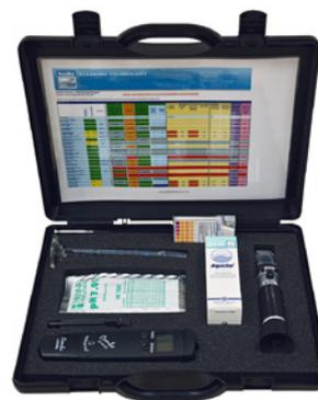
kolb ServiceCase 400 zur manuellen Refraktionsmessung
