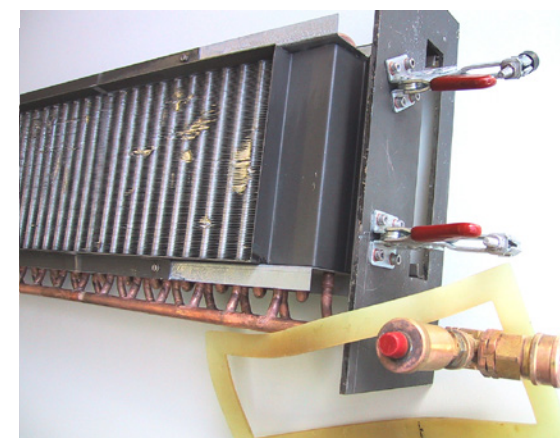
Die Kondensatfallen von acht Soltec Reflowöfen werden durch das kolb Reinigungssystem unter Einsparung von Kosten und Ressourcen gereinigt
