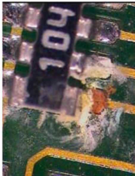
Durch Reinigung zu verhindern: Elektrochemische Migration führt zu Ausfall der Baugruppe
