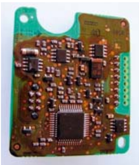
Lackierte Baugruppe: Richtige Reinigung erhöht die Haftkraft der Schutzbeschichtung um 50 Prozent
